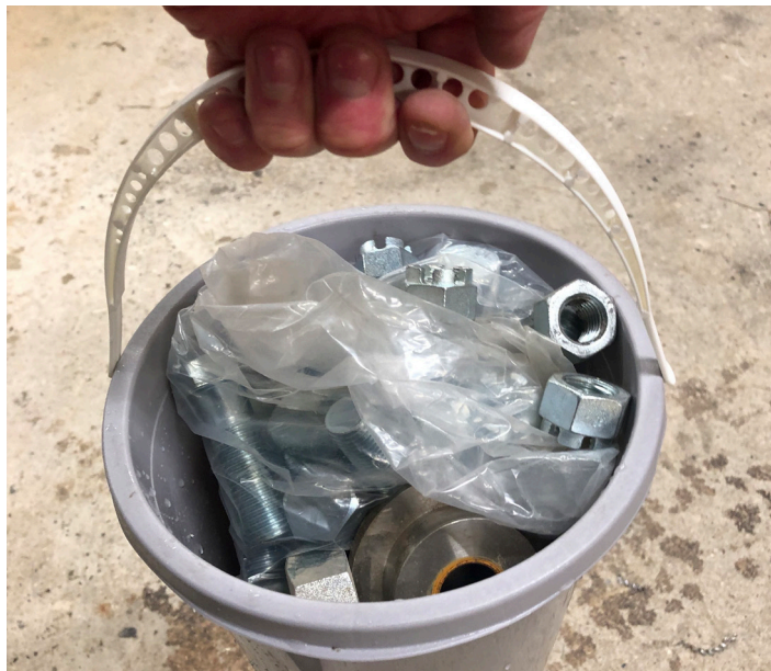
Billedet her viser en tilsvarende hank med en belastning på 10 kg
